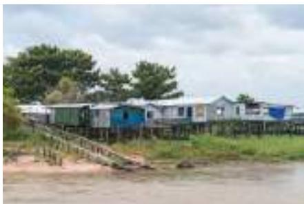
AS **PALAFITAS** SÃO FEITAS DE MADEIRA, CONSTRUÍDAS SOBRE ESTACAS, TAMBÉM DE MADEIRA, ACIMA DO NÍVEL DA ÁGUA DO RIO. ESSA TÉCNICA DE CONSTRUÇÃO É UTILIZADA PARA EVITAR QUE AS CASAS SE ENCHAM DE ÁGUA QUANDO O NÍVEL DO RIO AUMENTA.
