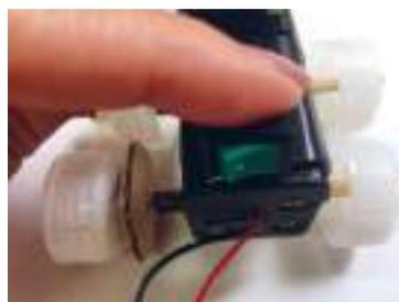
**9º passo:** Faça as ligações dos fios com o motor. E passe a fita isolante.
